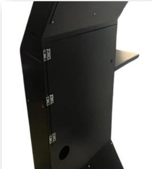
O processo de instalação da porta traseira é semelhante ao da porta frontal. A porta traseira já virá com as dobradiças instaladas, bastando fixá-la ao corpo do totem utilizando rebites e a rebitadeira. Neste caso, deverão ser anexadas **três dobradiças** na **parte externa do totem**.
