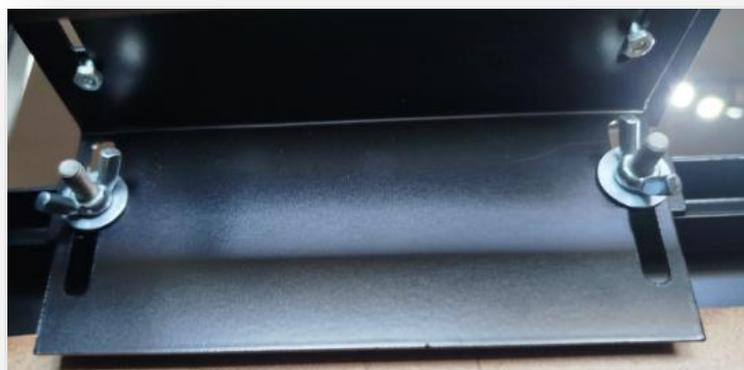
A instalação deste componente deve ser realizada no canto da abertura traseira do totem (observando-se a estrutura por trás). O suporte tipo “L” será fixado nas furações localizadas à esquerda, utilizando parafuso sextavado e porca borboleta, conforme ilustrado na imagem acima.
