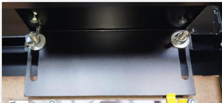
A instalação deste componente deve ser realizada no canto da abertura traseira do totem (observando-se a estrutura por trás). O suporte tipo “L” será fixado nas furações localizadas à direita, utilizando parafuso sextavado e porca borboleta, conforme ilustrado na imagem acima.
